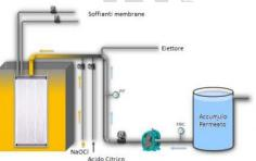
Le membrane sono contenute in appositi moduli e sono sommersi verticalmente nel fango attivo; per mantenere elevato il grado di filtrazione delle membrane, è insufflata aria dal basso così da mantenere in agitazione le singole fibre e mantenere pulita la loro superficie.
